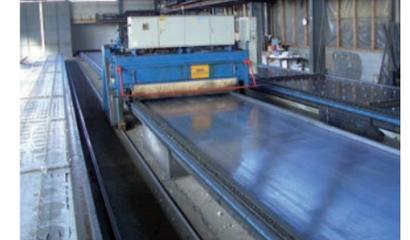
Reinigen und Ölen der Fertigungsbahnen mit anschließendem Einmessen und Aufzeichnen der Plattengeometrie auf der Stahlbahn.
