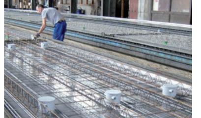
Fixierung der Einbauteile und Aussparungen auf der Fertigungsbahn und anschließendes Einbauen der Bewehrung exakt nach CAD-Vorgabe.
