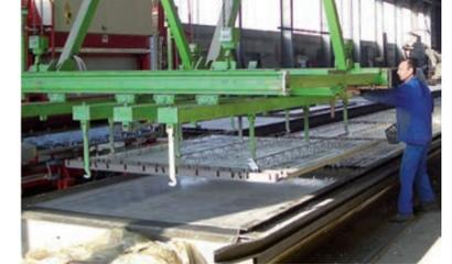
Ausschalen und Stapeln der einzelnen Platten mittels Abhebegerät zu fixierten Transportpaketen.
