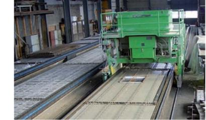
Verteilen und Verdichten des Betons durch die Betoniermaschine.
